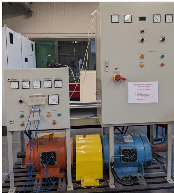
**Figure 3.1:** *Versuchsstand Synchronmaschine*
